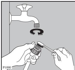
Закройте кран подачи воды. Открутите наливной шланг. Прочистите фильтр жесткой щеткой. Прикрутите на место наливной шланг.
